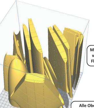
Material und Flussrate können angepasst werden um verschiedene Flächenbelastungen zu erreichen. Ein Flieger aus LW PLA bei 40% Fluss wiegt 200 Gramm.
