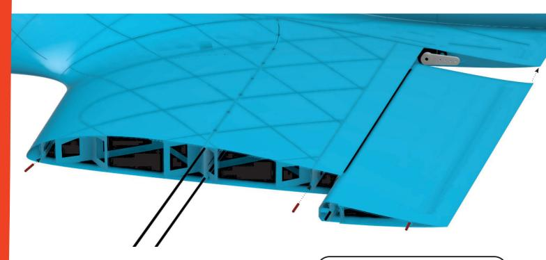
Die Ruder werden einfach auf den Servoarm geschoben. Bei einigen Servoarmen muss eventuell nachgeschnitten werden.
